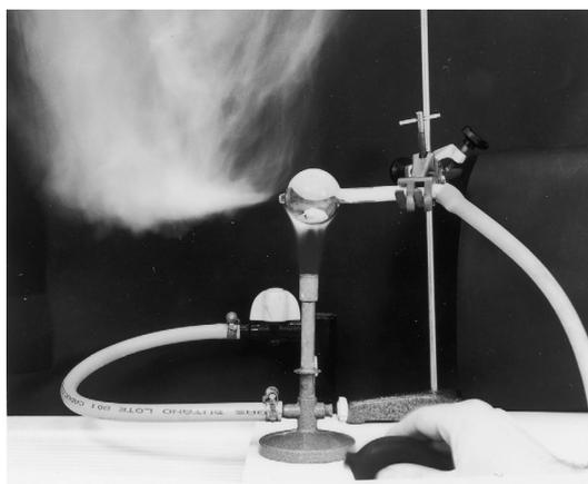
Fig. 10. Montaje de laboratorio para tinción con sublimado de cloruro amónico.
