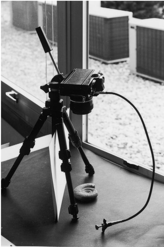
Fig. 4. La utilización de un trípode y un cable disparador permite la fotografía a velocidades de obturación lentas, necesarias muy a menudo en la fotografía paleontológica.
