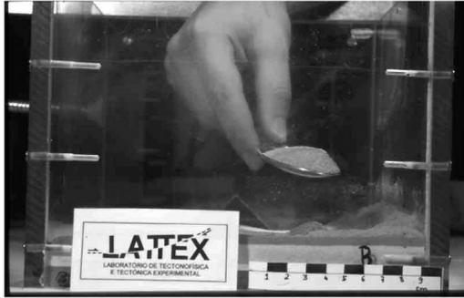
**Fig. 2** – La arena y el polvo se disponen formando estratos con ayuda de una cuchara, procurando que éstos sean regulares. Para ello se puede extender el material con la ayuda de una regla o cartón.
