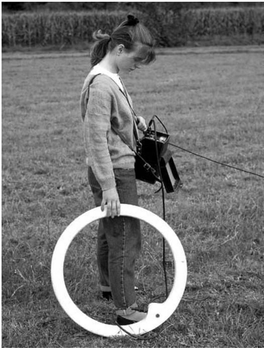
Figura 7.- Anillo receptor del equipo de sondeo electromagnético EM-34, GEONICS.
