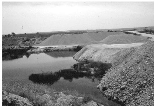
Figura 8. Cantera de explotación de áridos que ha sido explotada hasta que el nivel freático ha aflorado en superficie, dejando una laguna donde en primavera anidan aves, estamos en la zona de canteras de Velilla de San Antonio y Mejorada del Campo.
