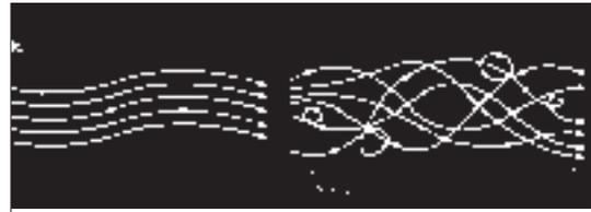
**Fig. 2** - Dos tipos de flujo presentes en el movimiento de un dado fluido.
