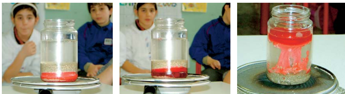
Fig. 2: Tres momentos del experimento de la cera: los alumnos han tenido la posibilidad de observar que la cera sólida (rojo claro), cuando se calienta se vuelve líquida (rojo oscuro) y se mueve hacia arriba, pasando a través de la arena superior sólida y de la agua, sobre la cual la cera flota y se vuelve nuevamente sólida.
