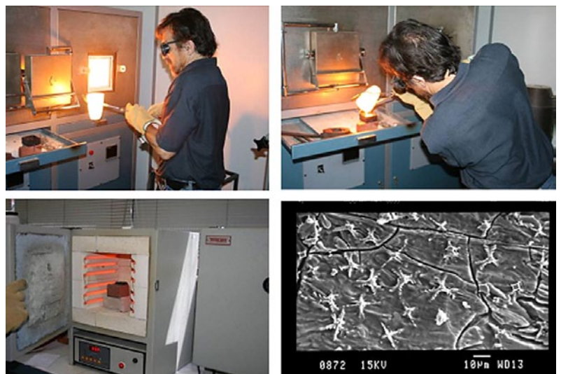
Fig. 6 (derecha). Vitrificación de un residuo. Proceso de fabricación del vidrio en el horno: fusión, colado, recocción e imagen del vidrio al microscopio electrónico de barrido donde se observan los núcleos y cristales formados
