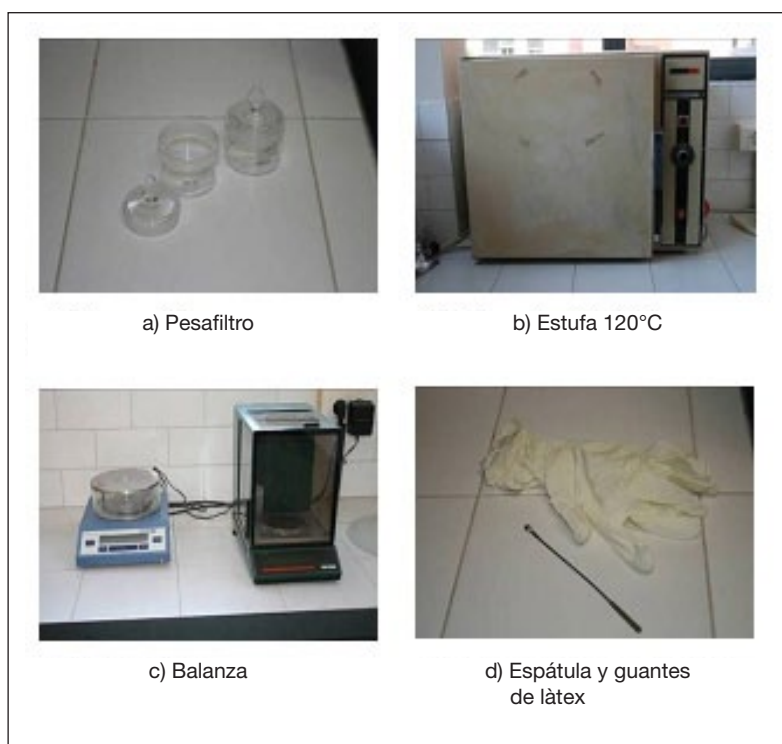
Fig. 8. Material de laboratorio necesario para la determinación de la humedad de los lodos y el proceso de secado.
