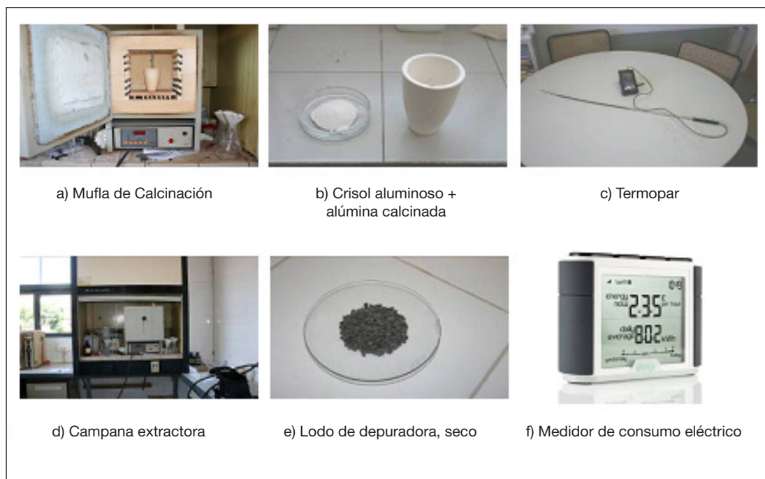
Fig. 10. Material de laboratorio necesario para la realización del estudio del efecto exotérmico y el poder calorífico de los lodos.
