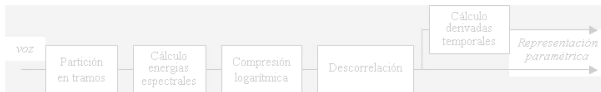
Figura 1 Esquema típico de determinación de los parámetros representativos de la envolvente espectral de cada tramo de señal de voz
