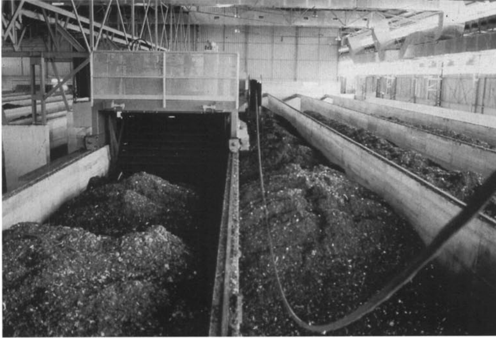
Planta de compostatge. La fracció orgànica dels residus sòlids urbans permet el seu tractament i la producció d'un compost orgànic utilitzable agrícolament. Fotografia: SAPRE.
