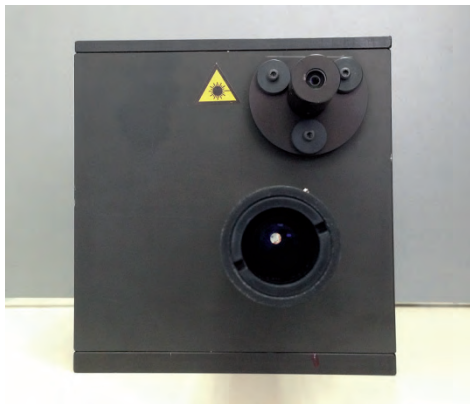
FIGURA 8. Càmera de temps de vol desenvolupada al CD6: a) vista frontal i b) vista lateral.
