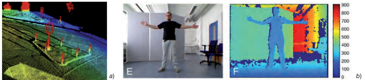
FIGURA 4. Exemples d'imatges 3D de temps de vol: a) escena exterior i b) escena interior (Schwarz et al. , 2012).
