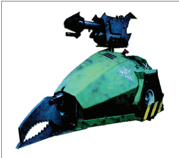
FIGURA 1. Sargent Bash, robot guerrer de 125 kg. Les seves dimensions són 140 x 90 x 90 cm i es pot moure fins a 8 mph. Entre les seves armes inclou un bufador de propà.
