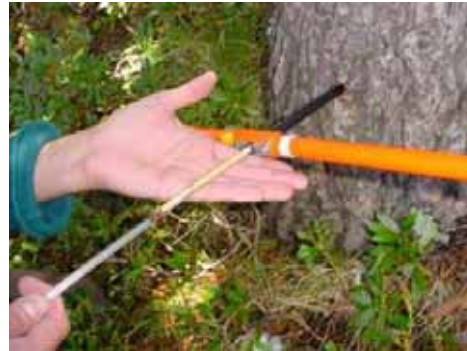
Extracció de testimonis de fusta mitjançant una barrina
