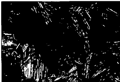
Figura 2. Micrografies en les quals s'observa la morfologia de la fase austenítica i la fase martensítica per a un aliatge CuZnAl.
