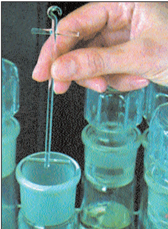
Muntatge per a l'assaig de migració per immersió total de la mostra.
