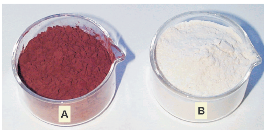
FIGURA 11. Mostres de FC no hidrolitzada (control) (A) i de l'hidrolitzat proteic de Hb mitjançant tripsina + pepsina (B) deshidratades per atomització.
