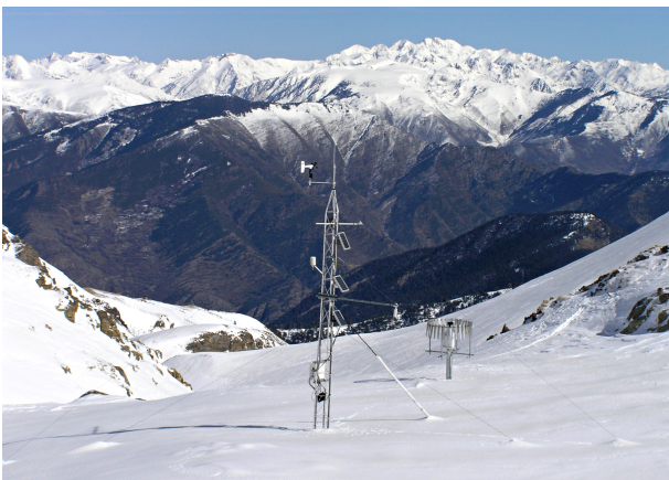
Figura 1: Estació meteorològica automàtica d'alta muntanya
