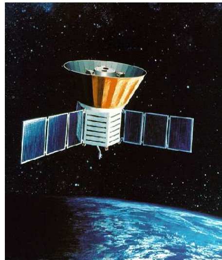
Figura 2: Representació artística del satèl·lit COBE operant en òrbita. Al centre de la pantalla protectora dels raigs solars es poden veure els diferents instruments a bord: el FIRAS (Far Infrared Absolute Spectrophotometer) per mesurar l'espectre, el DIRBE (Diffuse Infrared Background Experiment) per mesurar l'emissió infraroja de la Galàxia i les dues banyes del DMR (Differential Microwave Radiometer) per mesurar les anisotropies de l'RCF de manera diferencial. (Cortesia de NASA/COBE Science Team)
