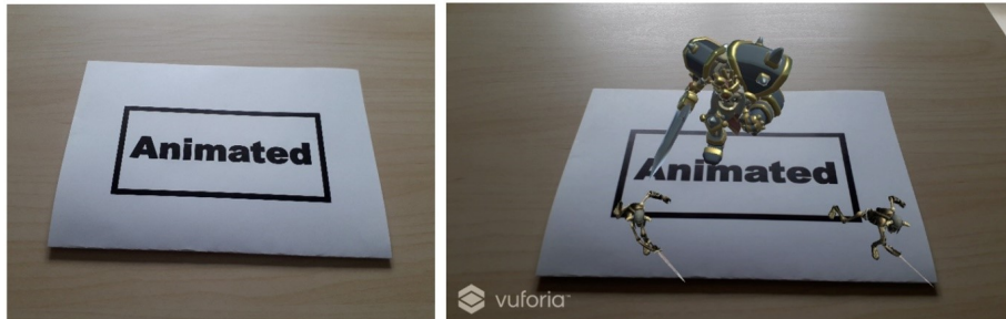
FIGURE 29 – Prototype d'affichage de trois modèles 3D animés en réalité augmentée : à gauche, le marqueur seul et, à droite, la vue en réalité augmentée
