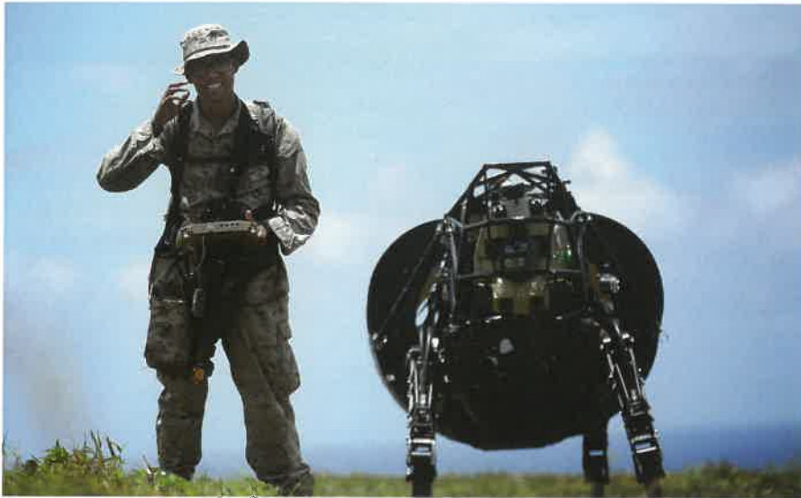
Le robot d'appui LS3. Comme nombre de mules, l'engin est programmé pour suivre son équipe. (© US Marine Corps)
