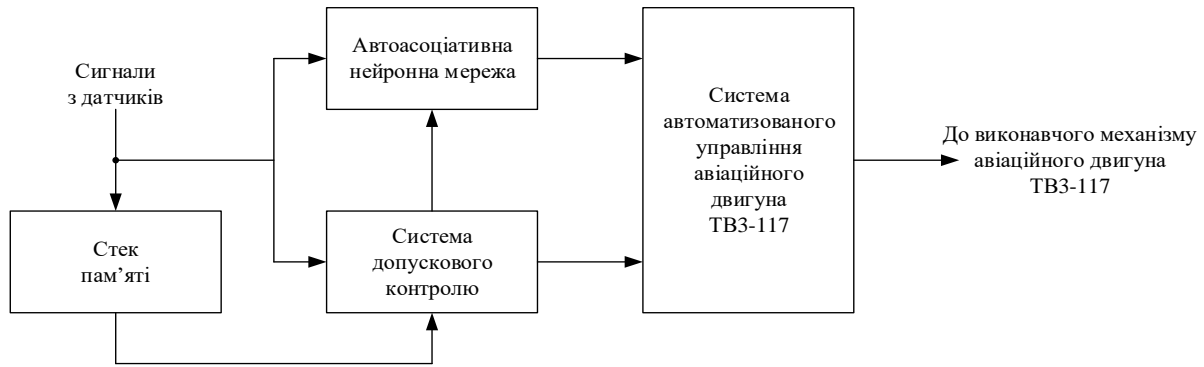
Рис. 2. Функціональна схема відновлення інформації на основі АНМ [10]
