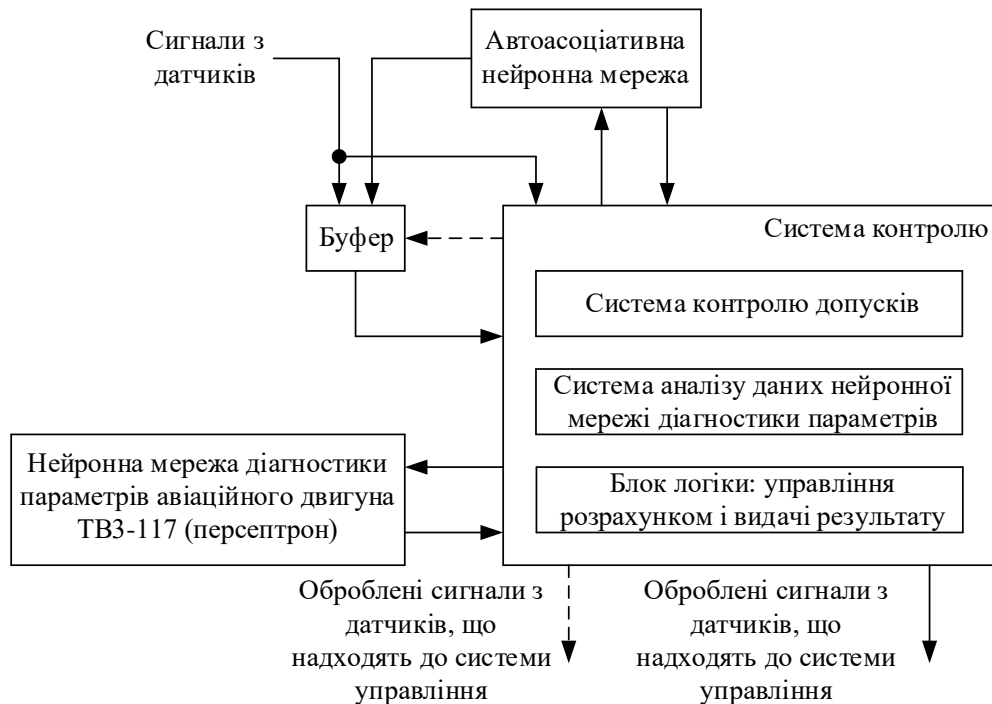
Рис. 6. Удосконалена функціональна схема відновлення втраченої інформації у БСКД
