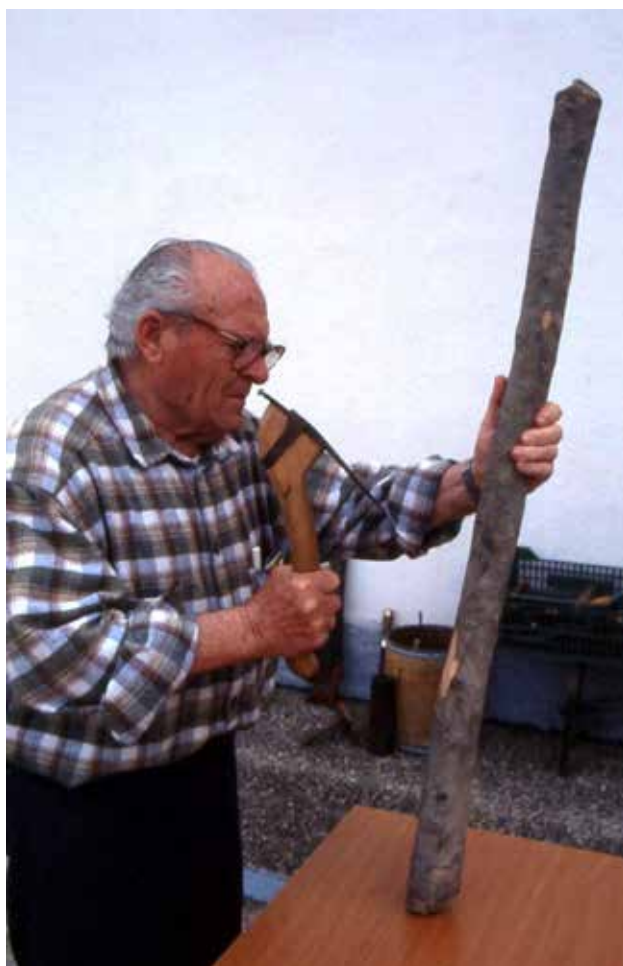
Mostrant com es desbasta una branca amb l'aixa. Fons CES
