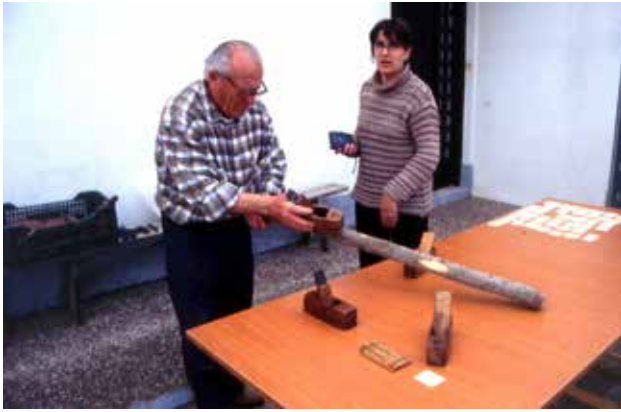
Treballant amb una planeta per indicar com es passa d'una branca a un mànec. Damunt la taula, el metre plegable. Fons CES
