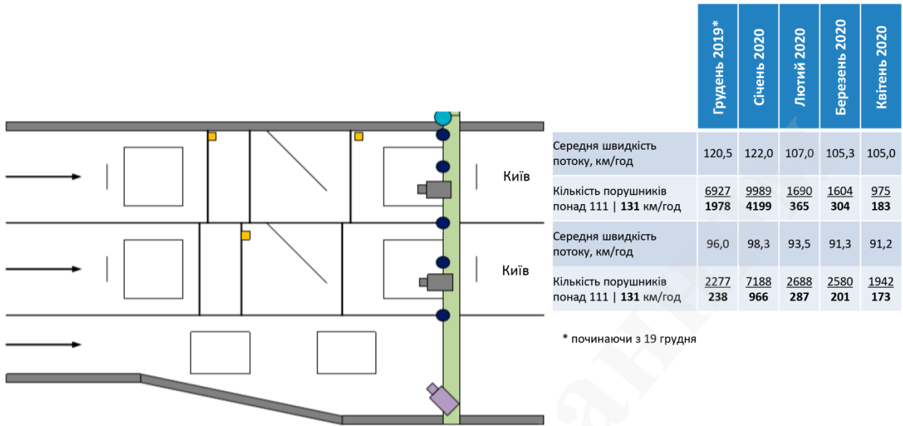
Рис. 9. Розподіл швидкостей на а/д М-06 на км 54+336 (WIM2, в бік Києва)
