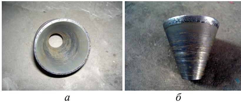
Рис. 12. Ознаки абразивно-корозійного зношування деталей пари тертя опори ковзання розчинозмішувача: a – вставки; б – цапфи
