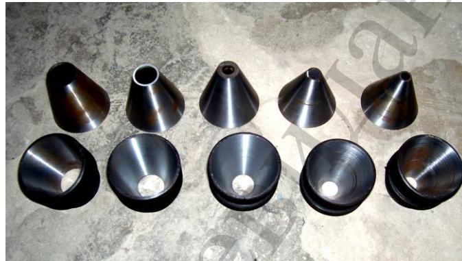
Рис. 10. Дослідні зразки цапфи опори ковзання із кутом \alpha при вершині: 30°, 35°, 40°, 45°, 50° (зліва направо)
