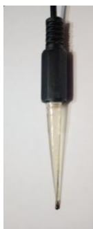
Рис. 5. Конструкція вимірювального зонду приладу.
