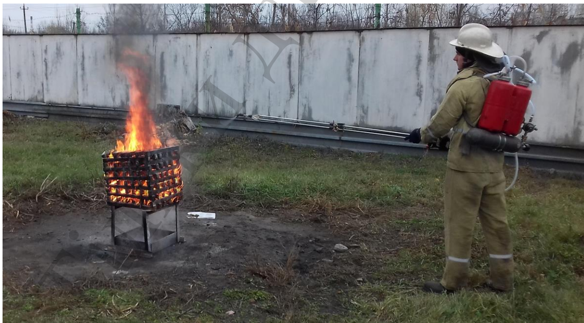
Рис. 4. Гасіння модельного вогнища 1А установкою гасіння гелеутворюючими складами з подовженим стволом колінчастого типу
