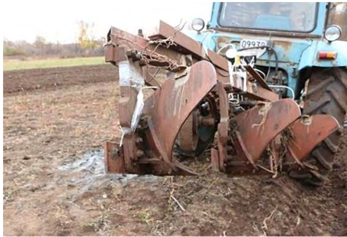
Рис. 13. Вигляд збоку польової дошки з тензорезистором встановленим на стійці третього корпусу плуга
