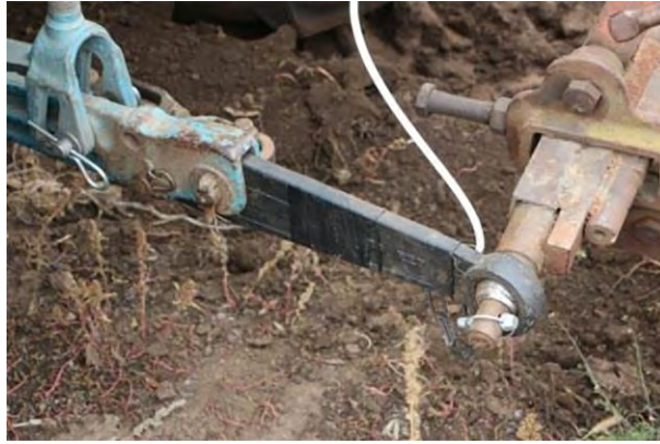
Рис. 10. Загальний вигляд тензорезистора встановленого на лівій тязі навіски трактора
