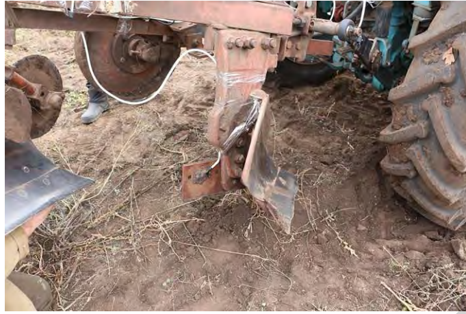
Рис. 17. Загальний вигляд тракторного агрегату з начіпним лемішним плугом ПЛН-3-35 та польової дошки з тензорезистором, встановленого на стійці першого корпусу плуга
