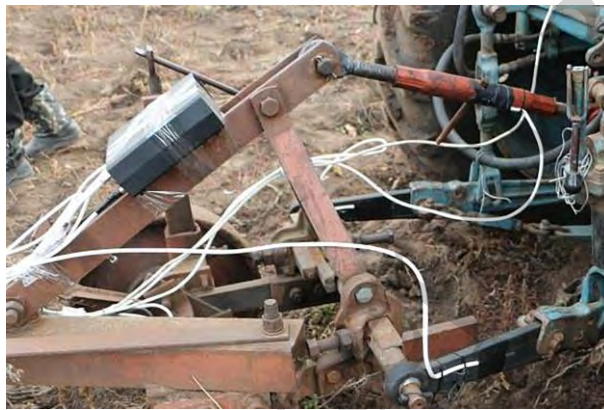
Рис. 11. Загальний вигляд тензорезистора встановленого на середній тязі навіски трактора
