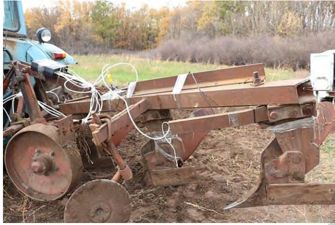
Рис. 15. Загальний вигляд трактора МТЗ-82 з начіпним лемішним плугом ПЛН-3-35 та польової дошки з тензорезистором, встановленої на стійці другого корпусу плуга
