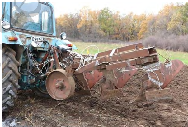
Рис. 12. Загальний вигляд трактора МТЗ-82 з начіпним лемішним плугом ПЛН-3-35 та польової дошки з тензорезистором встановленим на стійці третього корпусу плуга
