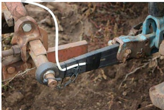
Рис. 9. Загальний вигляд тензорезистора, встановленого на правій тязі навіски трактора
