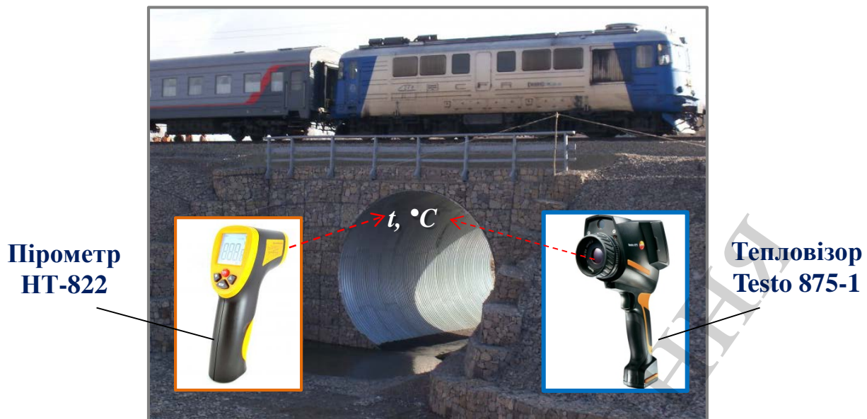
Рис. 1. Процес проведення вимірювань температури на поверхні металевого гофрованого листа труби
