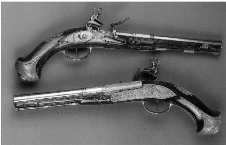
Parella de pistoles originària de Manresa amb clau a la "moda de Madrid". Llargada de 41 cms. Canons de 26 cms i 19 mm. Obra del pedrenyaler Fèlix Dulachs, el canoner Antoni Mas i de l'encepador Martí Jaumandreu, tots manresans. Font Ricard Martí
