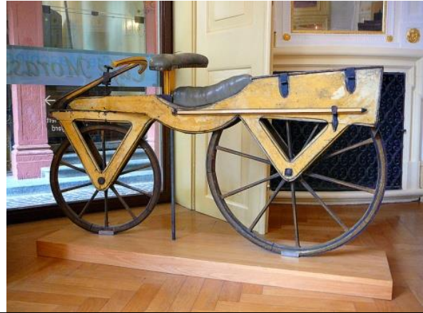
Figura 4. Prototip d'una draisina, l'avantpassat de les bicicletes, tal i com la va dissenyar Karl Drais al 1817.
