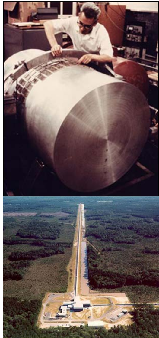
Figura 4. A dalt: Joseph Weber, pioner en la detecció d'ones gravitatòries a la dècada dels 60, amb un dels seus detectors d'ones gravitatòries. A baix: un dels dos braços del detector LIGO a Handford (EEUU). Cadascun dels braços de l'interferòmetre mesura 4km. Crèdits: LIGO
