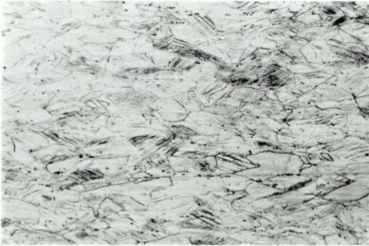
Fig. 2. - Microestructura d'una placa d'osteosíntesi d'acer inoxidable 316 L (austenític) vista al microscopi òptic. x 200.
