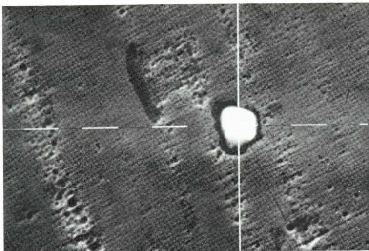
Fig. 3. - Inclusions no metàl·liques a l'interior d'una placa d'osteosíntesi trencada en servei, observades en el microscopi electrònic de rastreig. x 1.250.
