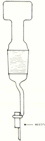
Fig. 1. Tap de vidre pyrex amb suport per a la mostra.
