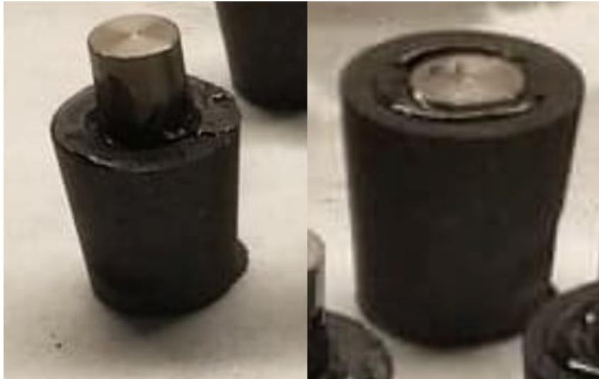
Figure 3.29 : Échantillon long (Gauche) et échantillon plat (Droite)
