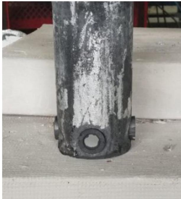
Figure 3.33 : Porte-échantillons après le test d'immersion de 96h
