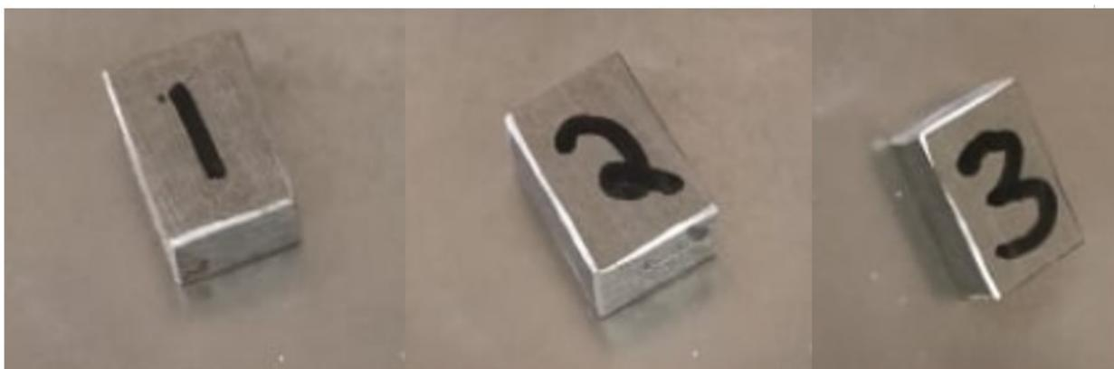
Figure 3.16 : Échantillons de fonte préparés pour la validation de la technique de nettoyage.
