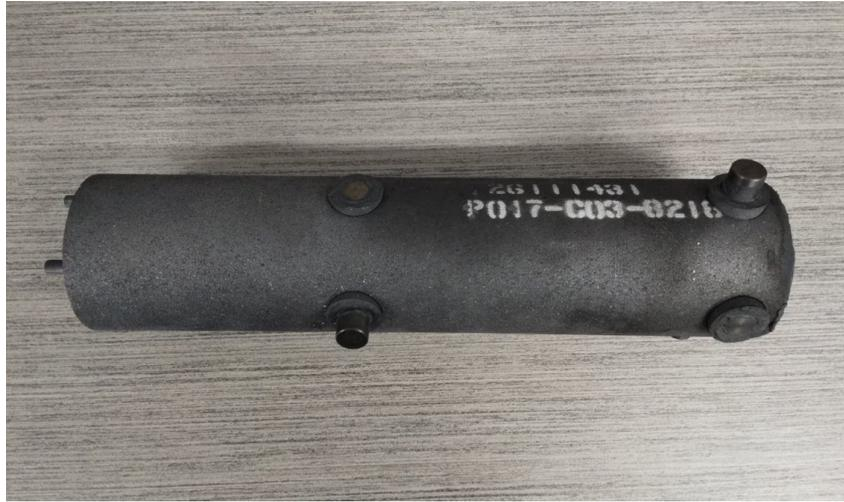
Figure 3.32 : Porte-échantillons avec ses échantillons de fonte grise avant le premier essai
