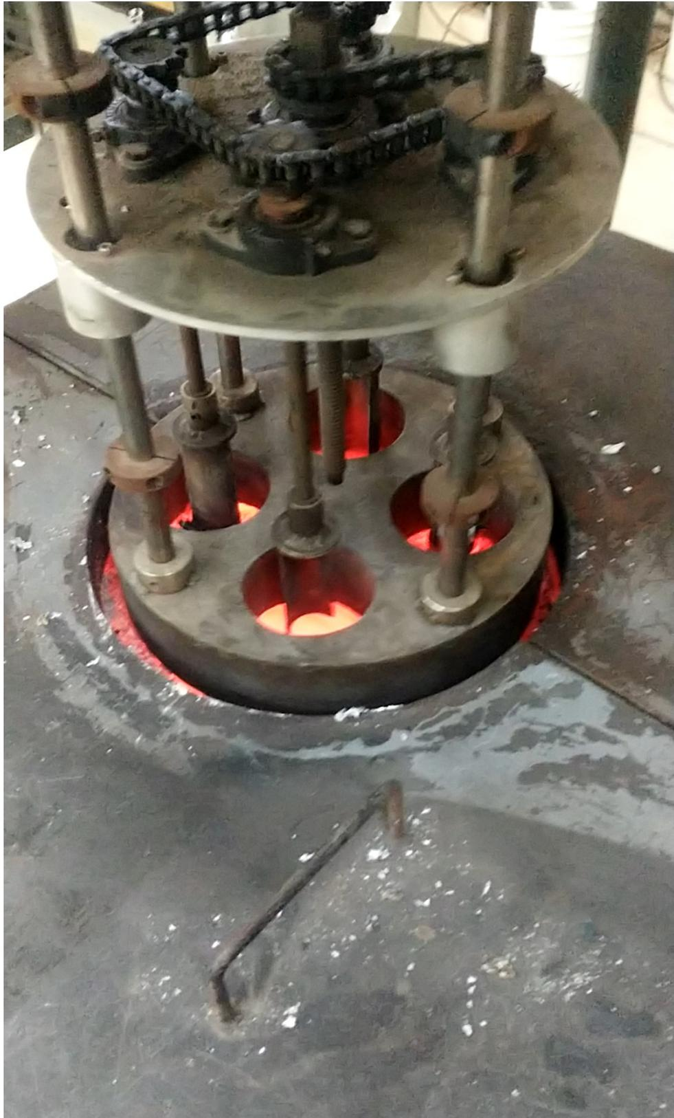
Figure 3.31 : Montage pour faire effectuer une rotation à des échantillons dans l'aluminium en fusion
