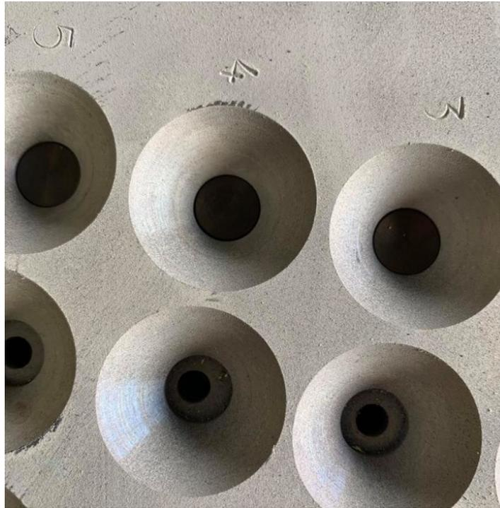
Figure 3.39 : Plaque machiné avec échantillons dans les orifices pour le test statique
