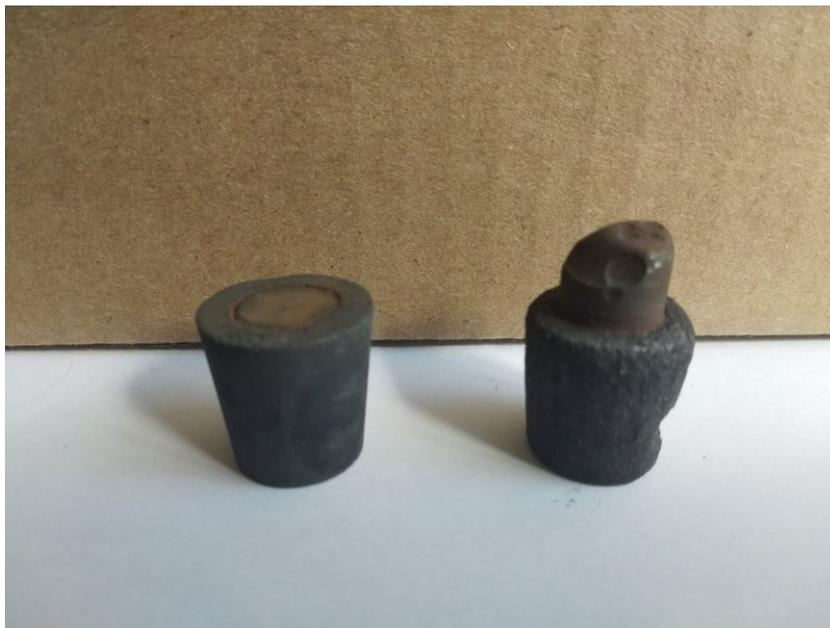
Figure 3.34 : Échantillons plats (Gauche) et long (Droite) après une immersion de 4h à 23cm de profondeur
