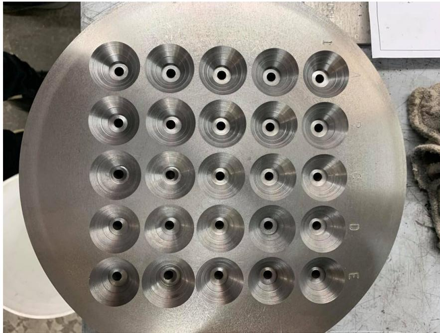
Figure 3.38 : Plaque machiné pour le test statique
