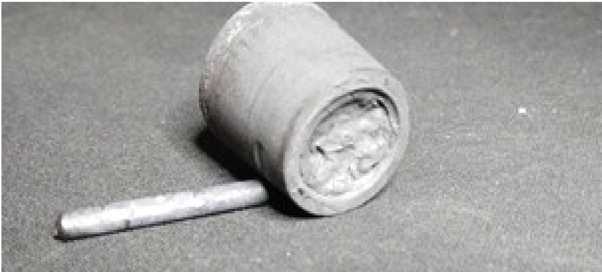
Figure 3.21 : Bague en graphite après le deuxième test ALCAN
