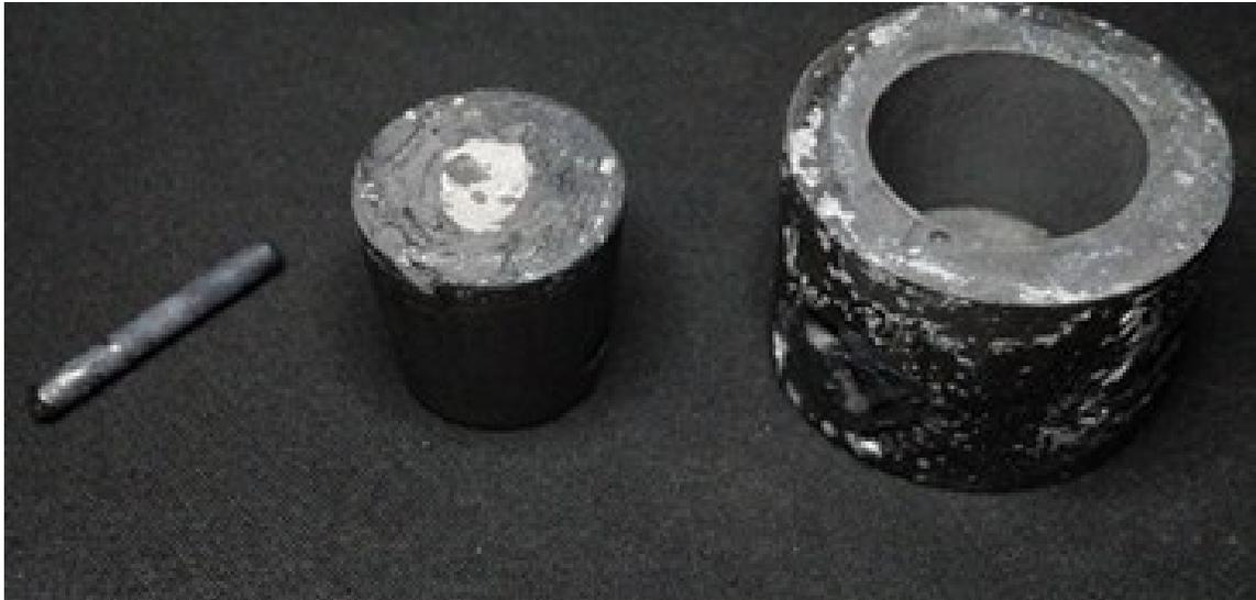
Figure 3.20 : Désassemblage du montage à la suite du deuxième test ALCAN
