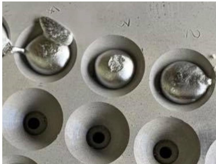
Figure 3.40 : La plaque machinée avec les échantillons recouverte d'une goutte d'aluminium pour le test statique
