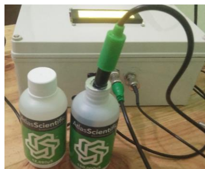
Gambar 9. Kalibrasi sensor salinitas
