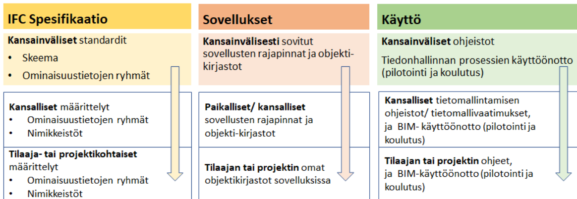
Kuva 9. Yhteentoimivuuden lisäkehittämisen käytännöt ja ohjeistukset IFC-määrittelyn, sovellusten ja käytön osalta. (Kuvälähde: Juha Hyvärinen)
