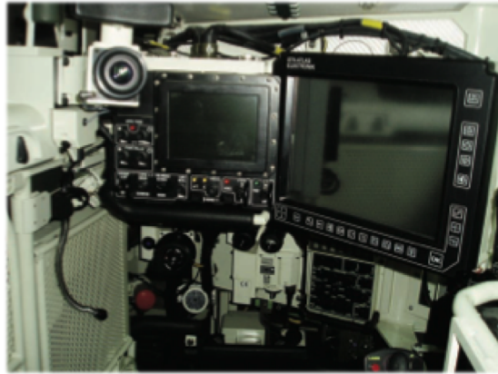
Figura 2: Monitor del sistema Lince en el puesto de jefe de carro Leopardo 2E 12 . A la derecha, el hardware del Lince por el cual el jefe de carro tiene acceso a los datos del sistema, como la posición de los carros amigos dentro del despliegue.
