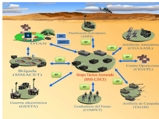
Figura 7: Esquema de interoperabilidad del BMS- Lince del PCBON Pizarro 31
