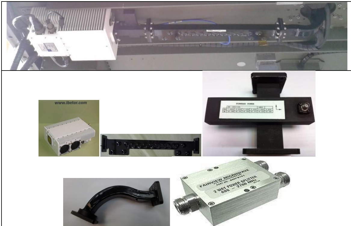
Imágenes 43,44,45,46,47,48 y 49 . BUC, Sistema de RF, Guía de ondas y Derivador de dos vías respectivamente.
