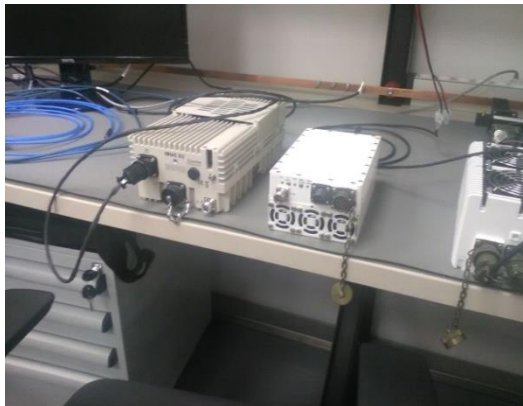
Imagen 17. BUC y LNB, presente en el SOTM-B. Fuente: "IBETOR".
