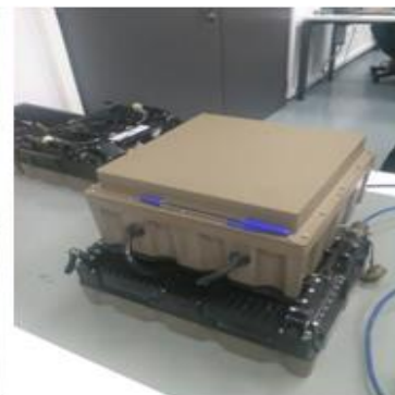
Imagen 16. Antena satelital Man-Pack. Fuente: Elaboración propia, IBETOR
