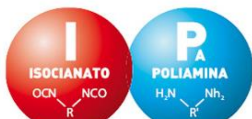
Figura 11: Composición de la poliurea. Fuente: www.tecnopol.es
