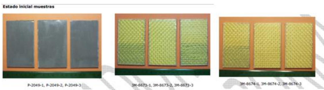
Figura 27: Abrasión. Estado inicial de las muestras. Fuente: Tecnalia. (2014). Estudio de resistencia a la abrasión por arena de recubrimientos de poliurea (No. 40090).
