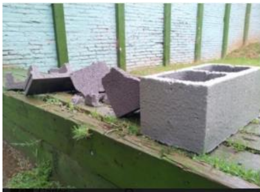
Figura 13: Comparación de impacto en bloque sin/con poliurea. Fuente: Indeo Engineering
