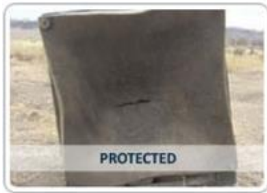
Figura 12: Comparación de daños sobre metales. Fuente: Indeo Engineering
