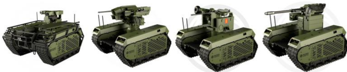
Ilustración 15 Ejemplos de diferentes tipos de armamento equipados sobre el THeMIS
