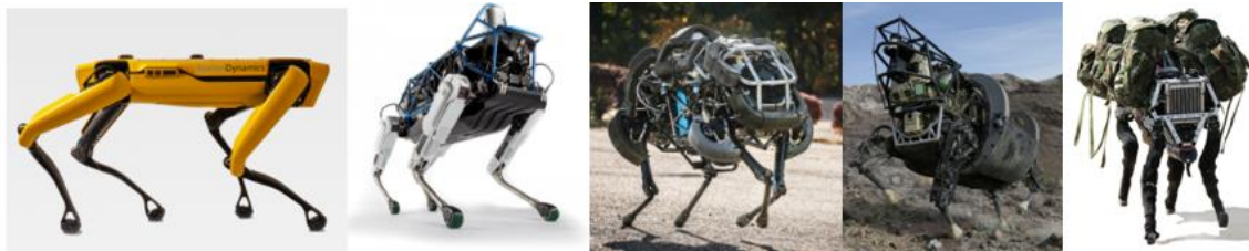
Ilustración 9 Robots cuadrúpedos Boston Dynamics. De izquierda a derecha: Spot Mini , Spot Classic , Wildcat , LS3 y Big Dog .
