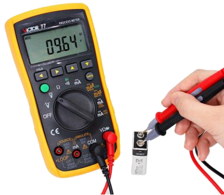
Figura 8. Multímetro en configuración de medida de voltaje.
