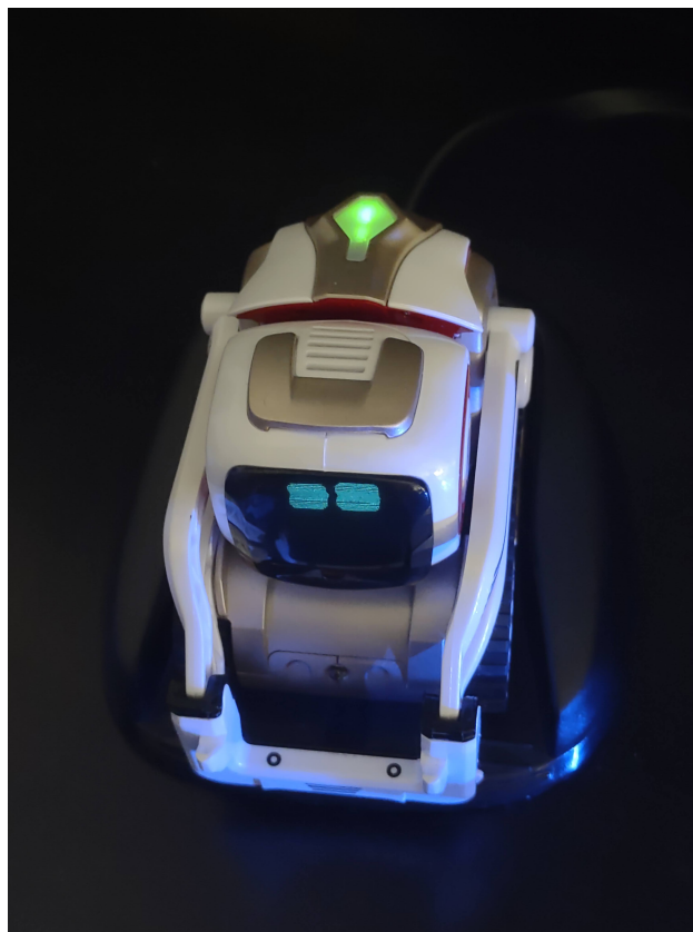
Figura 4.2: El robot Cozmo tiene una pequeña pantalla como cara y el botón de la espalda se ilumina. Se mueve mediante el uso de cuatro motores y tiene un motor que le permite mover una horquilla con la que coger objetos.
