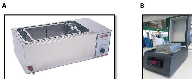
Figura 3.5. Tratamiento térmico en un baño termostático con agitación (A) o en un termobloque de aluminio (B).
