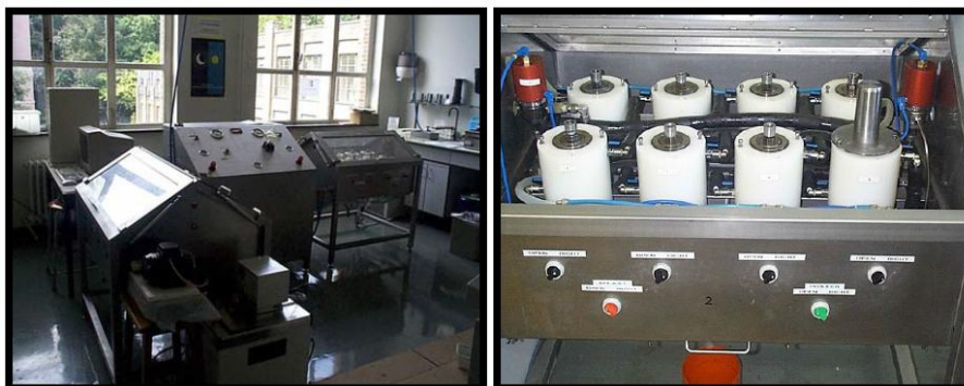
Figura 3.7. Equipo de tratamiento para las altas presiones hidrostáticas (KU Leuven, Lovaina, Bélgica).
