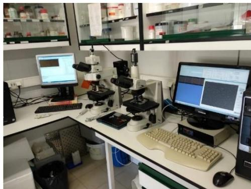
**Figura 5.2.** Equipos de evaluación espermática del laboratorio del departamento. A la derecha los aparatos utilizados para analizar motilidad, y a la izquierda los necesarios para analizar los ensayos de quimiotaxis. Imagen tomada el 10/03/2020.
