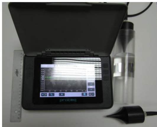
Figura 2: Imagen del Pundit PL-200 tomada en el laboratorio. Consiste en una pantalla táctil, 2 transductores de 54 kHz, 2 cables BCN de 1,5 cm, acoplador, varilla de calibración, cable adaptador BNC, fuente de alimentación y cable USB ( www.proceq.com ).
