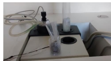
Fig .9- Susceptómetro KLY3.
