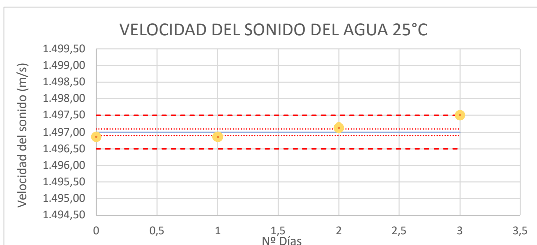
Figura 4: Representación de la velocidad del sonido, u , del agua mili-Q desgasificada frente al número de días a 298,15 K. • : Resultados experimentales; — : Valores de referencia [15]; - - - ; Margen de precisión del aparato; ..... ; Margen de reproducibilidad del aparato.
