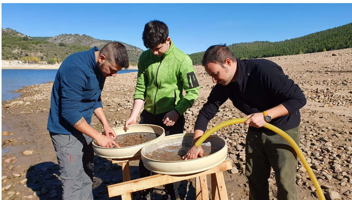
Figura 2: Fotografía tomada durante el proceso de lavado-tamizado de los sedimentos con bomba de agua y tamices de distinto tamaño de luz de malla. Peña Capón 2019.
