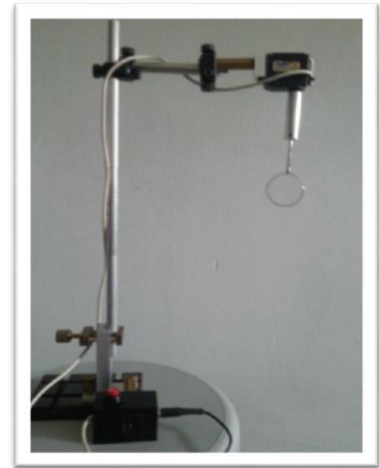
Figura 13. Montaje motor + cilindro cruzado
