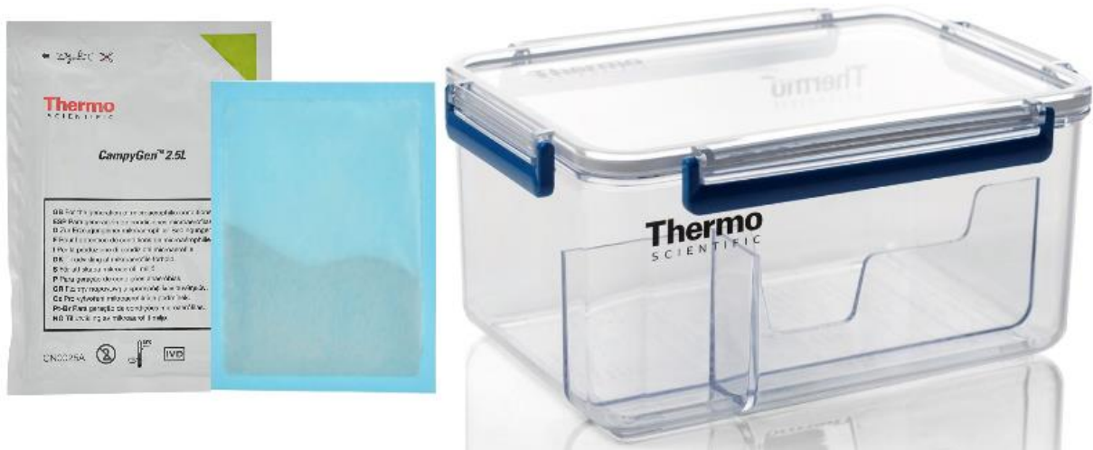
Figura 3. Sistema de cultivo para H. pylori comercializado por la empresa Thermo Fisher Scientific Inc. (EE.UU.), compuesto por una caja con tapa de cierre hermético y sobres de atmósfera microaeróbica. Imagen tomada del Catálogo de Productos de Thermo Fisher Scientific.
