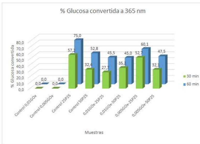
**Figura 17.** Representación de la actividad de GOx libre, P25 sin enzima y de los híbridos GOx-P25 después de irradiar las muestras a 365 nm
